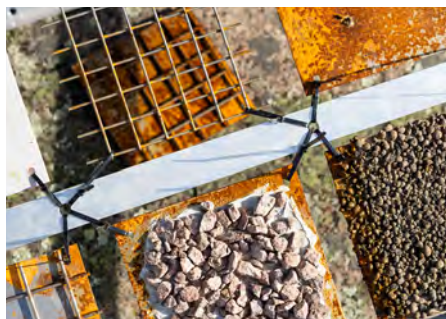
Tester pågår. Vilka material, ytor och vinklar attraherar det marina livet mest?
